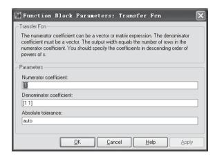
Figure 4.8. Transfer function parameters dialog box.
