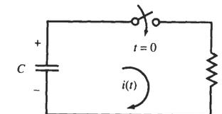
Fig. 3-20  $RC$  circuit.
