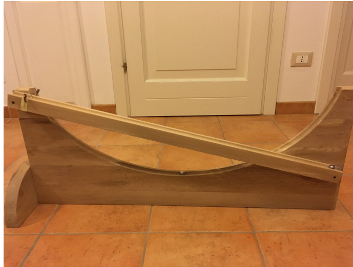
Figura 10. L'esperimento dello studente Federico Fallucca (Meccanica Classica e Analitica 2015-16) sulla brachistocrona, presentato alla Notte Europea dei Ricercatori 2016. Il modello mostra come la pallina vincolata a rotolare su una cicloide arrivi prima rispetto a quella vincolata a una retta inclinata.
